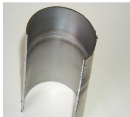
Soldadura con cinta:
